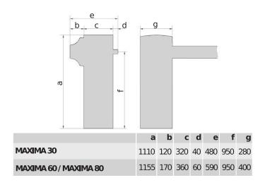
Gamme de barrières électromécaniques professionnelles 230 Vca à haute fréquence d'utilisation, étudiées et conçues pour fonctionner dans les conditions d'utilisation les plus diverses comme les grands parkings, les péages autoroutiers à inversions de fonctionnement fréquentes, les installations industrielles. Mouvement mécanique à bielle manivelle assurant la fluidité et l'harmonie de la barre, tout en gérant les ralentissements en ouverture et fermeture.
